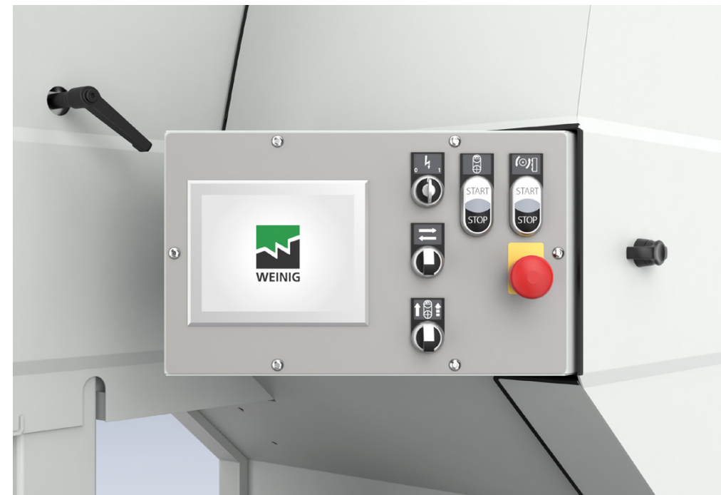
Touchscreen zur einfachen Eingabe von Bandsägeblatt- und Vorschubgeschwindigkeit (frequenzgeregelt), sowie Trennmaße zur Positionierung des Breitenanschlags
