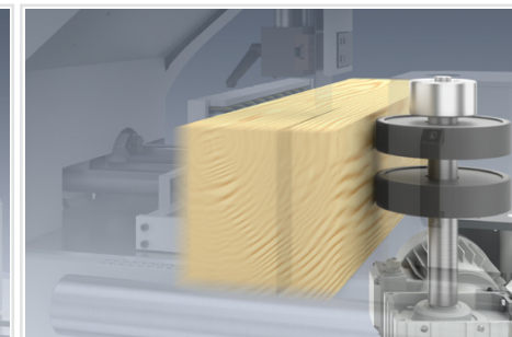
Frequenz geregelter, stufenloser Vorschub 5 - 40 m/min
